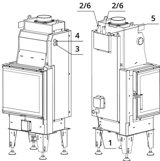
1. Entrée d'eau froide dans l'échangeur, filetage extérieur 1"
