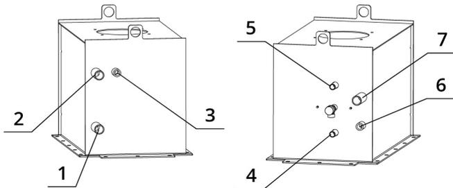
1. Entrée d'eau froide dans l'échangeur, filetage extérieur 1"
